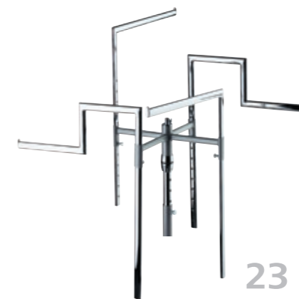
Typ 44 2 Tragarme stufig 600 mm lang Stufenhöhe 150 mm 2 Tragarme gerade 600 mm lang separat höhenverstellbar Warenstangen aus Ovalrohr 35 x 20 mm
