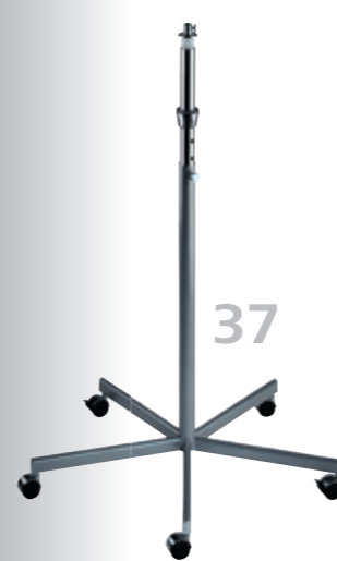
Typ 17-5/F* 5-teilig Tunnelrohrprofil 40 x 20 mm fahrbar auf Ø 50 mm Doppelaufrollen (M10)
